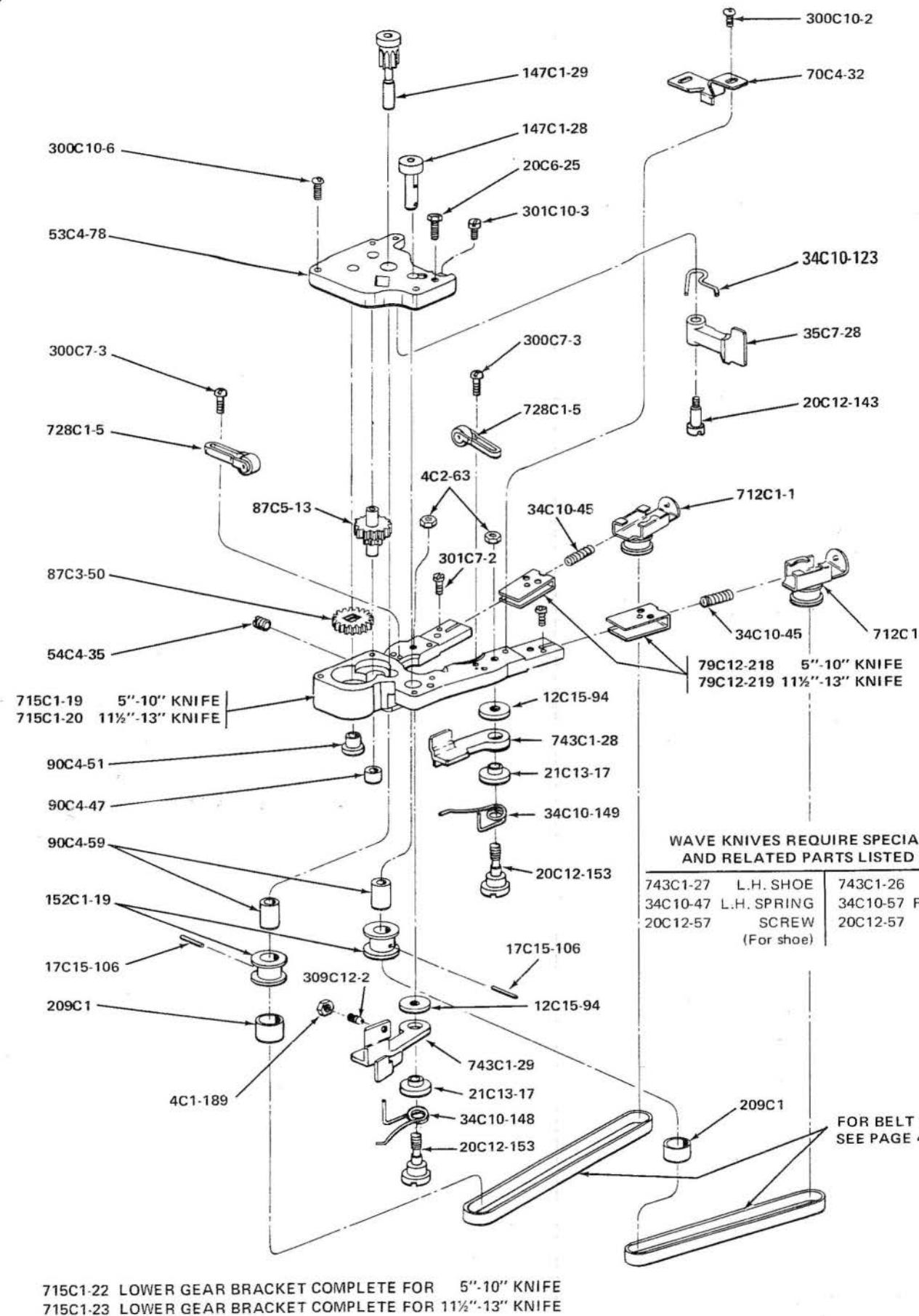
715C1-22 LOWER GEAR BRACKET COMPLETE FOR 5"-10" KNIFE
